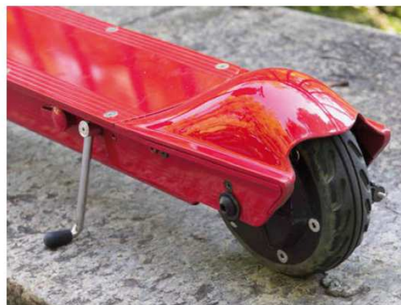
Hinterrad mit Nabenmotor und Trommelbremse. Links neben der Seitenständer-Achse die Ladebuchse.
