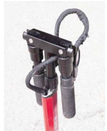
Der Lenker kann zum Transport eingeklappt werden.
