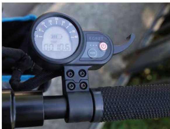
Das Kombiinstrument. Rechts neben dem roten Hauptschalter der „Gashebel“.
